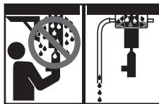
*Ne fixer la colonne de forage avec la pompe à vide que sur une surface plane, solide et lisse. En cas de perçage au-dessus de la hauteur de la tête, **toujours** employer une bague de recueil d'eau et un aspirateur d'eau. Ceux-ci doivent être dans un état irréprochable.*
