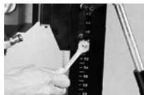
Si vous utilisez une colonne de forage, veillez à l'ajustement correct des coulisseaux. Les coulisseaux des perceuses sont équipés d'une bande de glissement permettant le réglage fin sur la colonne de forage.
